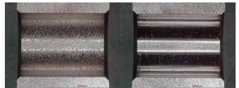
図3: ふれまわり放電テクスチャリングの加工例
