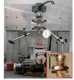
図2: ふれまわり放電加工装置
