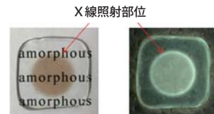
図4. 開発した放射線線量計用蛍光ガラスとX線照射によって誘起された蛍光(ラジオフォトルミネッセンス)
