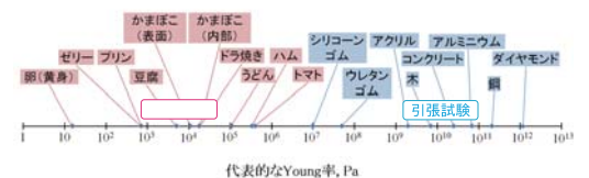
図3.あらゆる素材を、共通の指標(弾性係数)で評価可能とする計測法
