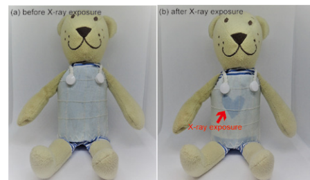
図3. 放射線可視化材料(可逆型)の人形用エプロン (左)放射線照射前、(右)放射線照射後 ※ハート型に濃く見えている部分が放射線照射箇所
