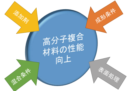
図1. 充填材(フィラー)の「分散」を制御することで性能向上を図る
