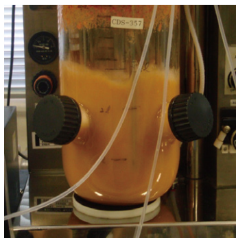
トウモロコシの芯(コーンコブ)を原料としたアスタキサンチン生産
