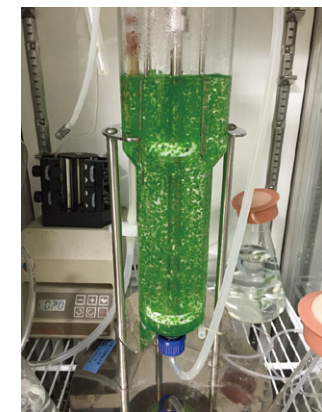
固定化エアリフトバイオリアクターによる遺伝子組み換え藍藻を用いたバイオアルコール生産
