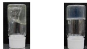
図2 分子量分布が異なるポリマーを用いて作製した高分子ゲル
