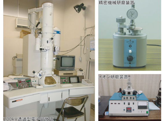
図1. (左)透過型電子顕微鏡、(右)薄膜試料作製装置類
