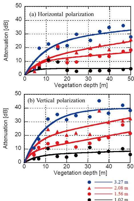
図2. 桑の成長に対する伝搬損失の距離特性の変化。
