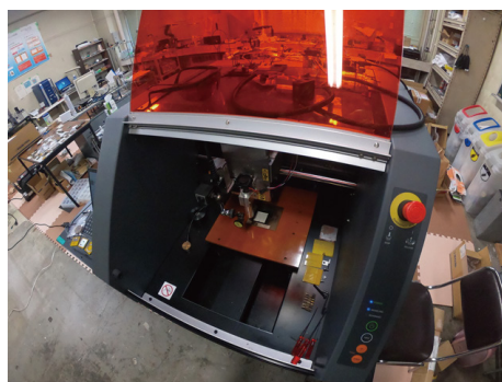
図1 開発した4軸レーザー加工機
