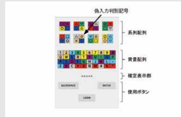
Fig.2——カラーパネルを用いた独自の認証方式
