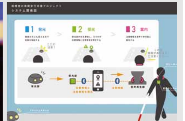
Fig.3——歩行支援システムの仕組み
