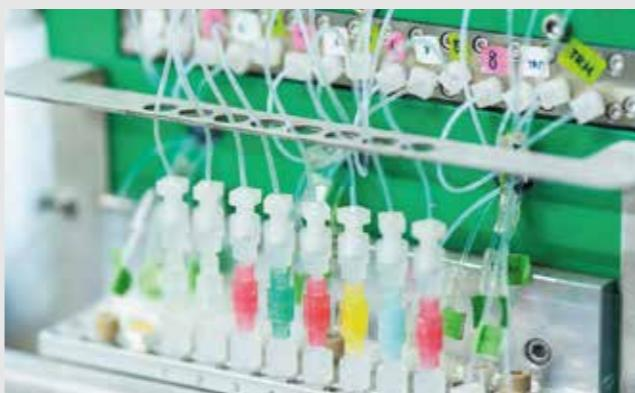
Fig.2——自動合成機を利用したDNA合成
