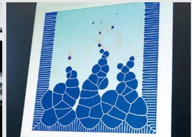
Fig.3——青い固体が成長する凝固のシミュレーション
