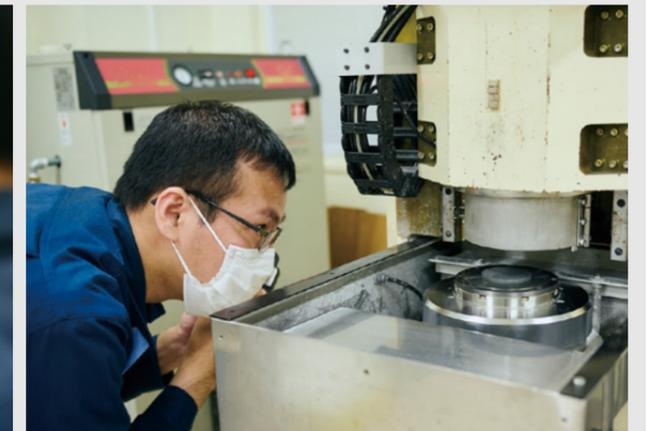
Fig.3——SiCやダイヤモンドなどの鏡面研磨の様子
