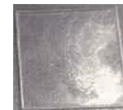
図4 本材料をガラス基板上にスピコートし、100°Cで加熱し成膜したもの
