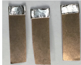
図3 紙などの多孔質材料に成膜。材料内部まで浸透。
